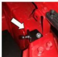
2. Установить кронштейн крыла в отверстие через закладную, уперев его в ребро жесткости и затянуть болт ключом №13 с усилием 23 Нм.
