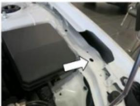
1. Завести под отверстие в кузове гайку закладную M8x50.
