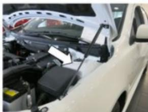
2. Установить кронштейн крыла, закрепив его к кузову болтом M8x30 с шайбой 8. Плотно прижать подгиб кронштейна к кузову и затянуть болт ключом №13 с усилием 23 Нм.
